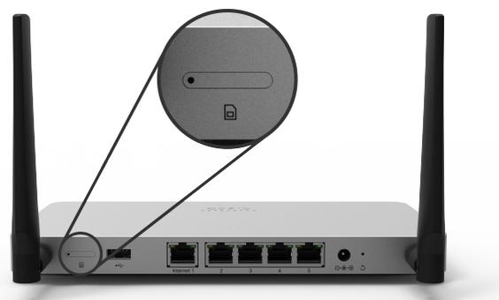
MX67C 上的 SIM 卡插槽
