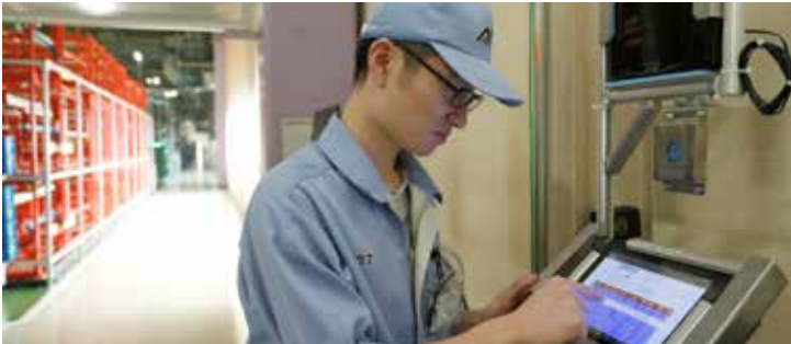
出荷管理情報はタッチパネル式のタブレット端末から無線 LAN を通じて ホスト コンピューターに集積する
